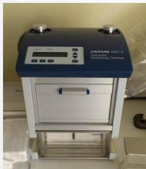
système de développement, CAMAG automatic developing chamber (ADC2)
