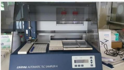
déposeur HPTLC, CAMAG automatic TLC sampler 4
